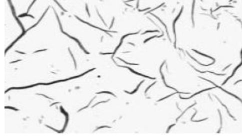
شكل الكرافيت الشرائحي (X100 (Unetched) البنية المجهرية (X500 (Etched) الشكل (1): البنية المجهرية لحديد الصب الرمادي البيرلايتي
